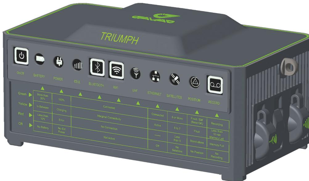
Новый мощный и надежный приемник для высокоточных навигационных систем основанный на СБИС с 864 каналами, оснащенный встроенным 4G/LTE/3G модулем, со съемными картами microSD и microSIM, поддерживает технологию «Lift&Tilt» (Держи и наклоняй).
